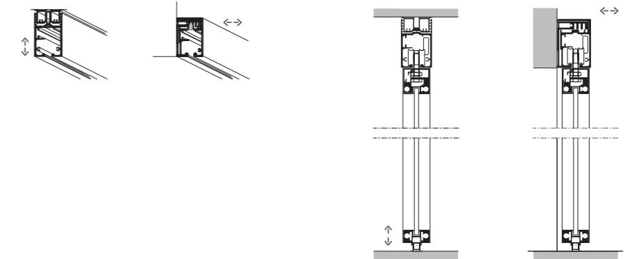
Il carrello consente la regolazione verticale del pannello scorrevole | The truck allows vertical adjustments of the sliding panel | Le chariot permet le réglage vertical du panneau coulissant | Der Wagen ermöglicht eine vertikale Einstellung der Schiebetür | El carrito permite el ajuste vertical del panel corredero
