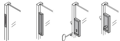
Stipite telaio anta anche in essenza. Possibilità' di avere pannelli con serratura a chiave o nottolino | Jamb door frame also in essence. Possibility of having panels with key lock or latch | Cadre de la porte de jambage en bois. Possibilité d'avoir des panneaux avec serrure à clé ou un verrou | Türrahmenfosten auch im Holz. Möglichkeit die Platten mit Schloss oder Riegel zu haben | Marco de la puerta también en madera. Posibilidad de tener paneles con cerradura de llave o cerrojo
