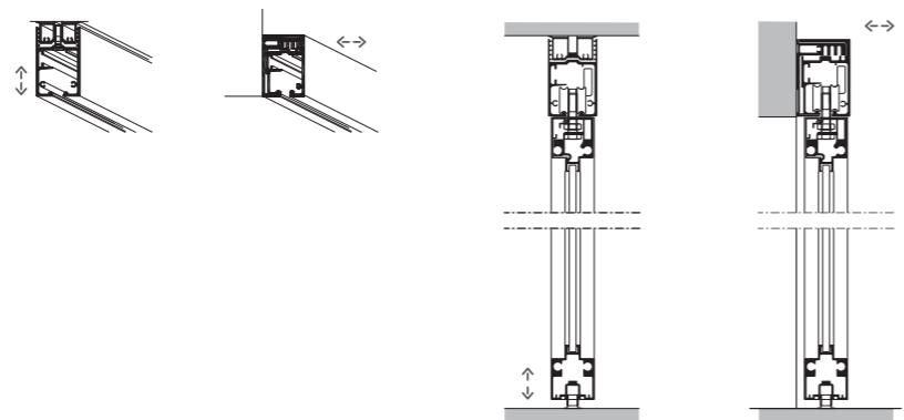
Il carrello consente la regolazione verticale del pannello scorrevole | The truck allows vertical adjustments of the sliding panel | Le chariot permet le réglage vertical du panneau coulissant | Der Wagen ermöglicht eine vertikale Einstellung der Schiebetür | El carrito permite el ajuste vertical del panel corredero
