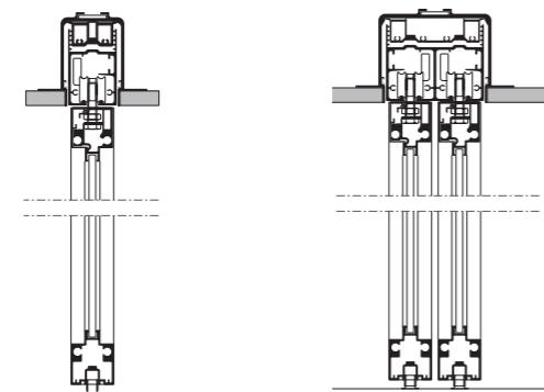
Applicazione su cartongesso con binario a 1,2 vie incassato a filo del soffitto | Application of plasterboard with 1,2-way built-in ceiling rail | Application sur placoplâtre avec rail 1,2 voies au plafond encaissé | Anwendung auf Gipskartonplatten mit 1,2-Wege eingelassene Deckenschiene | Aplicación al placard con el binario de 1,2 vías a ras del techo
